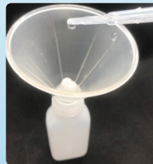
ภาพที่ 39 หยดน้ำยา Extract-1 ปริมาตรประมาณ 0.25 มิลลิลิตร ลงบนสำลี
